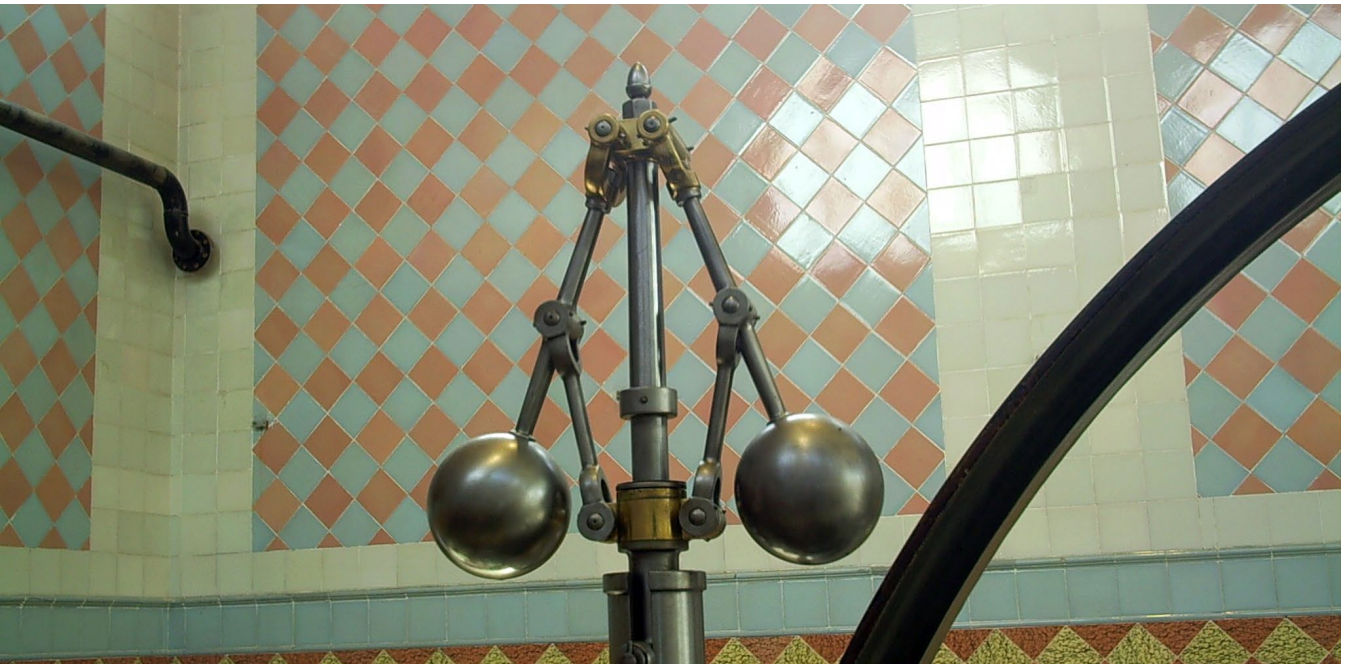
Detalle del regulador de Watt, de la máquina de vapor, en el Museu Nacional de la Ciència i la Tècnica de Catalunya (mNACTEC), ubicado en Terrassa. Fuente: Wikimedia Commons.
