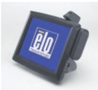
800x600 puntos y un brillo de 250 cd/m<sub>2</sub>. El ángulo de visión horizontal es de 120° y de 100° el vertical. El ratio de contraste es de 200:1. La pantalla táctil que incorpora este monitor es de 12,1" AccuTouch de tecnología resistiva. El acabado es anti-reflejo y el controlador puede ser serie RS-232 o USB.
