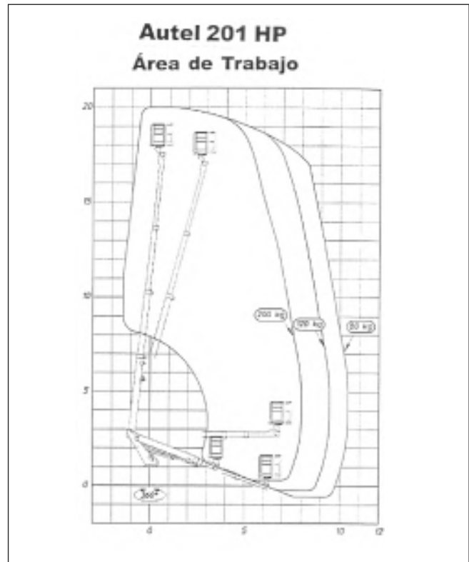
Figura 2. Diagrama de limitación de alcances en razón de los pesos sobre la cesta de la plataforma elevadora de personal.
