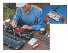
empalme óptico Fibrlok, que está especificado para aplicaciones de fibra, como sustituto a conectores y acopladores. Está diseñado con la filosofía de "cuanto más sencillo, mejor".
