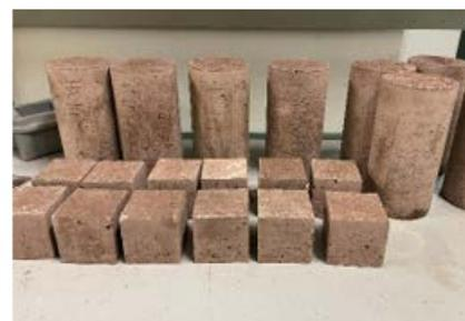
Figura 1. Probetas desmoldeadas HAC-C (izquierda) y HAC-100A (derecha).
