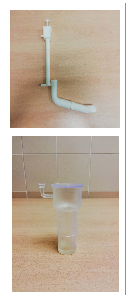
Figura 7. Impresión de piezas con diferentes técnicas (deposición de hilo fundido y estereolitografía).
